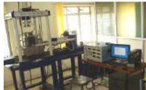
स्वचालित डेटा अधिग्रहण प्रणाली के साथ प्रत्यक्ष कतरनी परीक्षण उपकरण की स्थापना
