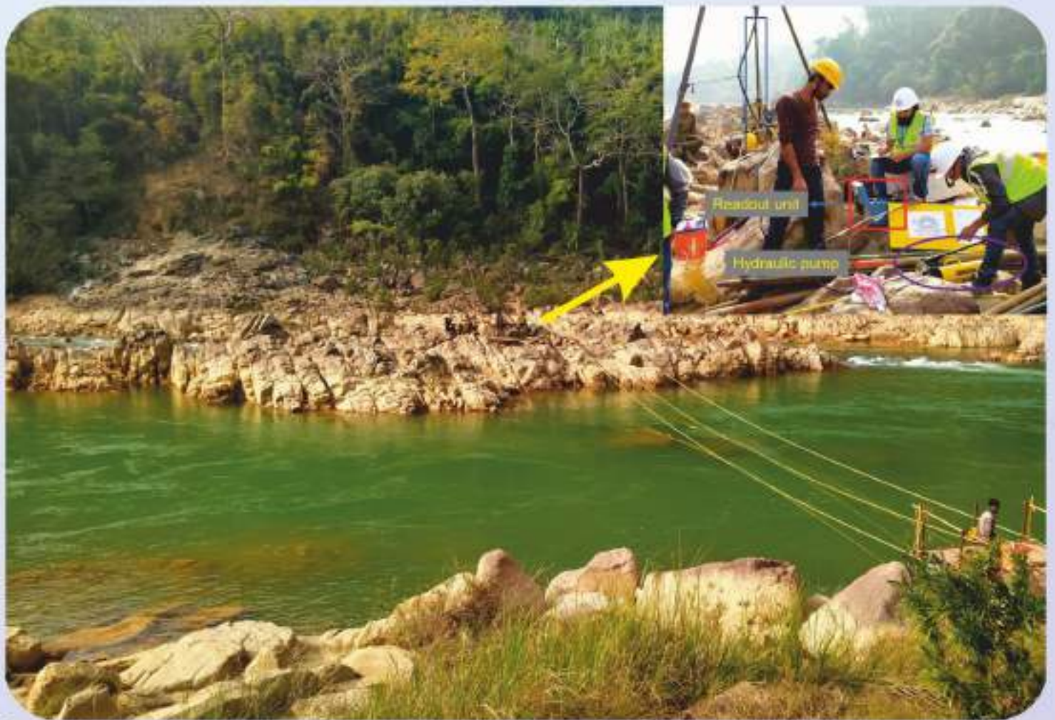
निचली कोपिली जलविद्युत परियोजना असम के नदी तल के केंद्र में वेधन किए गए बोर होल में गुडमैन जैक परिक्षण किया गया। परिक्षण के दौरान क्लोजअप दृश्य दिखाते हुए इनसेट।
