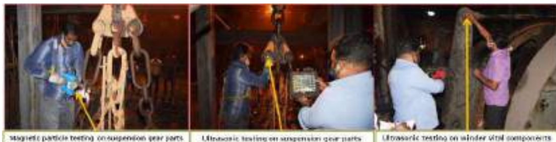
वाइंडर के महत्वपूर्ण घटकों और सस्पेंशन गियर भागों का परीक्षण
