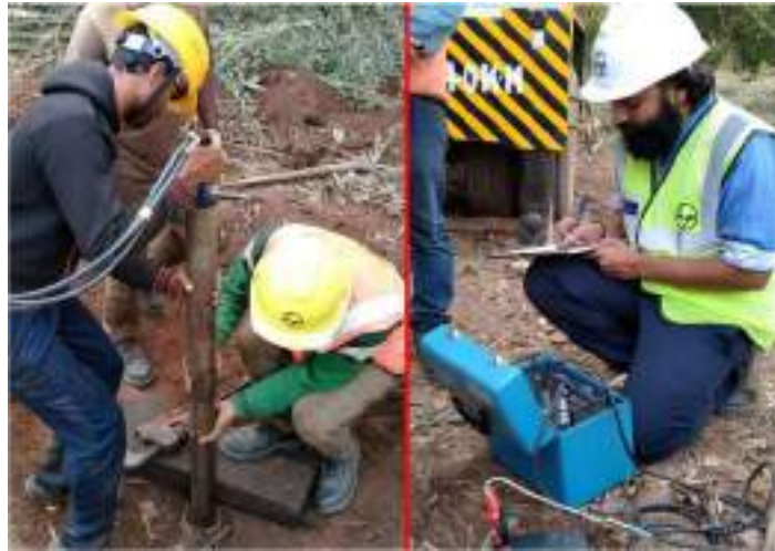
परीक्षण स्थान एसएस1 पर गुडमैन जैक परीक्षण प्रगति पर है
