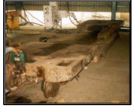
मानव चालित हालेज कार ट्राली एवं रोप एंकर के चुम्बकीय कणों का परीक्षण
