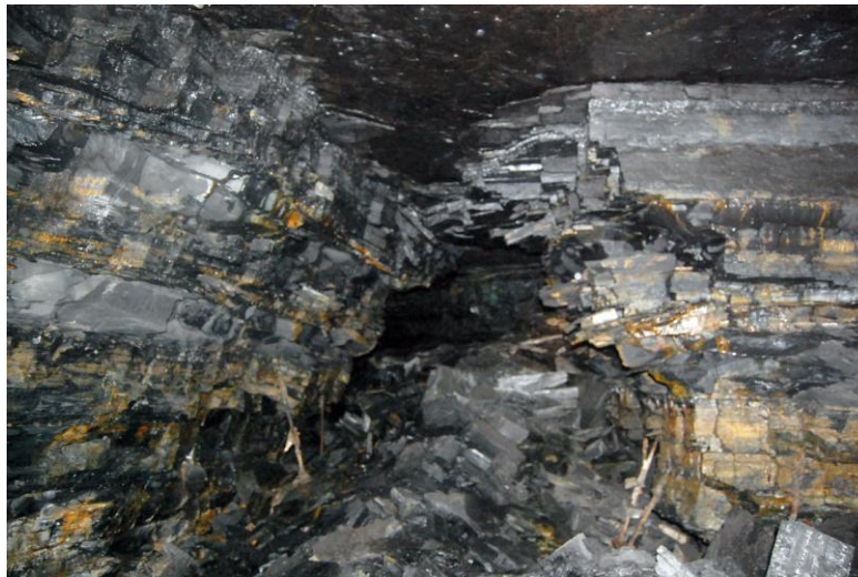
चित्र 7.2 मोहन कोलियरी में कोयला शेल का इण्टरकलेशन से उत्पन्न छत की कमजोर स्थिति
