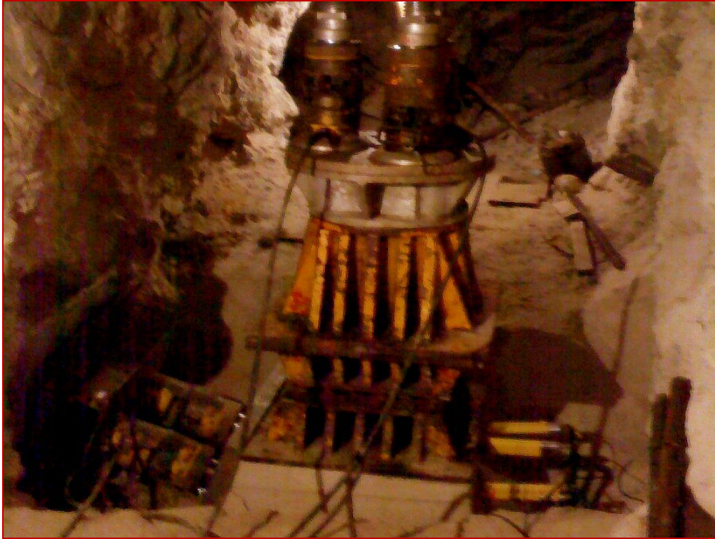
चित्र 3.2 मंगदेछू पन बिजली परियोजना के अंतर्गत बॉध के बाएँ किनारे पर डिफ्रैक्ट के भीतर इन-सीटू शियर का अध्ययन ।
