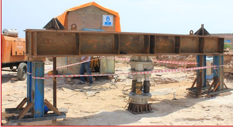
चित्र 3.1 इन-सीटू डीफार्मबिलिटी अध्ययन के लिए स्थापित उपकरण
