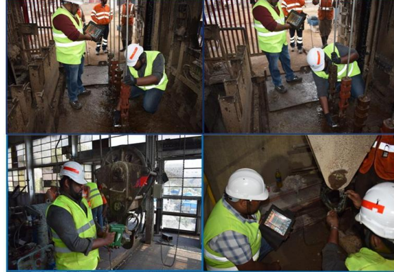
वाइंडर निलंबन गियर पार्ट्स और चैन चरखी ब्लॉक, जवार समूह ऑफ माइन्स, एचजेडएल के लिये एनडीटी परीक्षण
