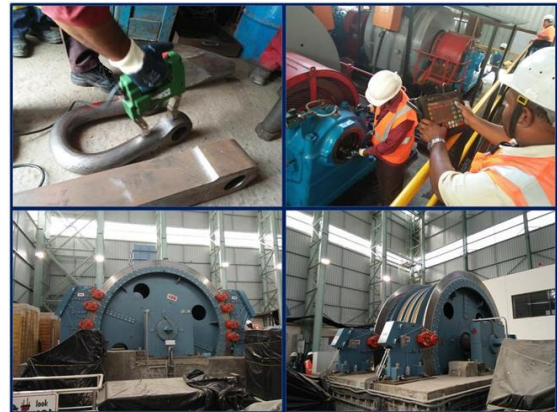
वाइडर / चरखी महत्वपूर्ण घटकों और किबल संलग्नक पर एनडीटी परीक्षण
