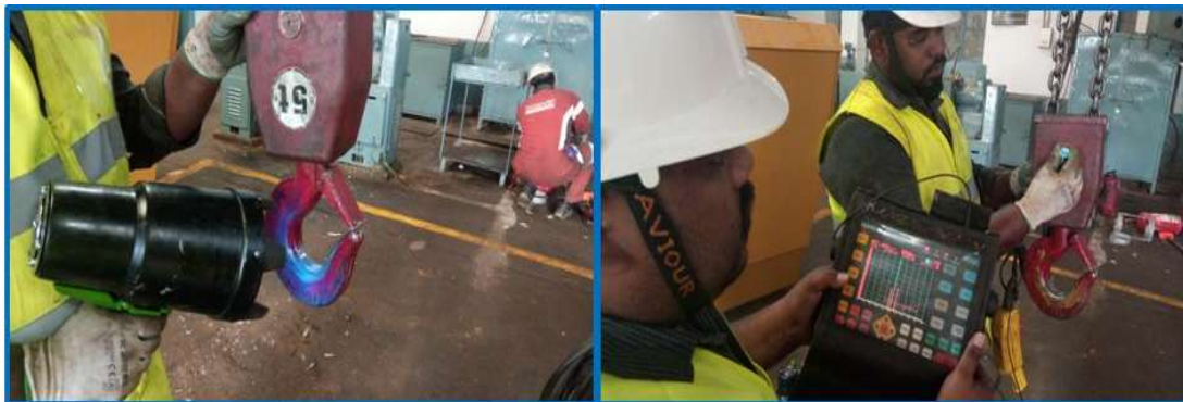
चेन पुल्ली हुक पर चुंबकीय कण और अल्ट्रासोनिक परीक्षा
