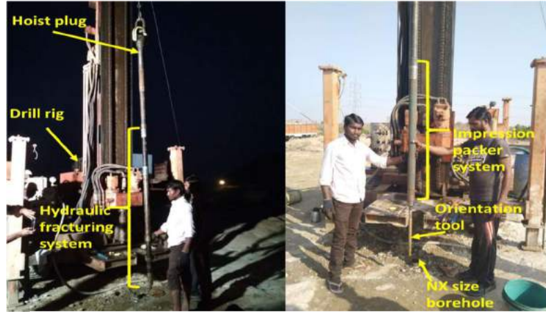
NQ छड़ के साथ हाइड्रोलिक फ्रैक्चरिंग उपकरण को नीचे करना
