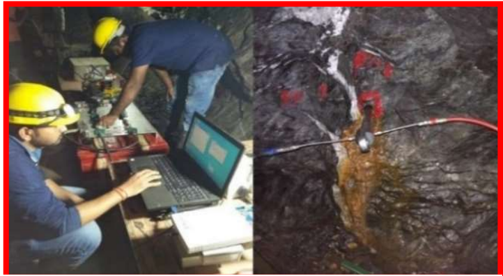
बोरहोल नंबर 1 पर हाइड्रोलिक फ्रैक्चरिंग परीक्षण का निष्पादन
