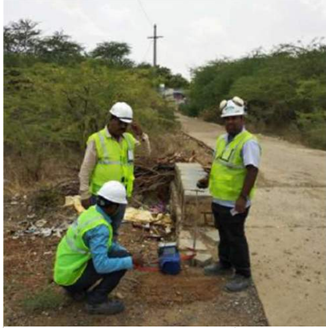
वलासपल्ली गांव के पश्चिमी प्रवेश द्वार के पास भू-कंपन और हवा के अधिक दबाव की निगरानी करते हुए
