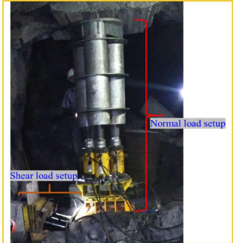
चासनाला गहरी खदान में परीक्षण स्थान पर प्रत्यक्ष कतरनी परीक्षण उपकरण सेटअप
