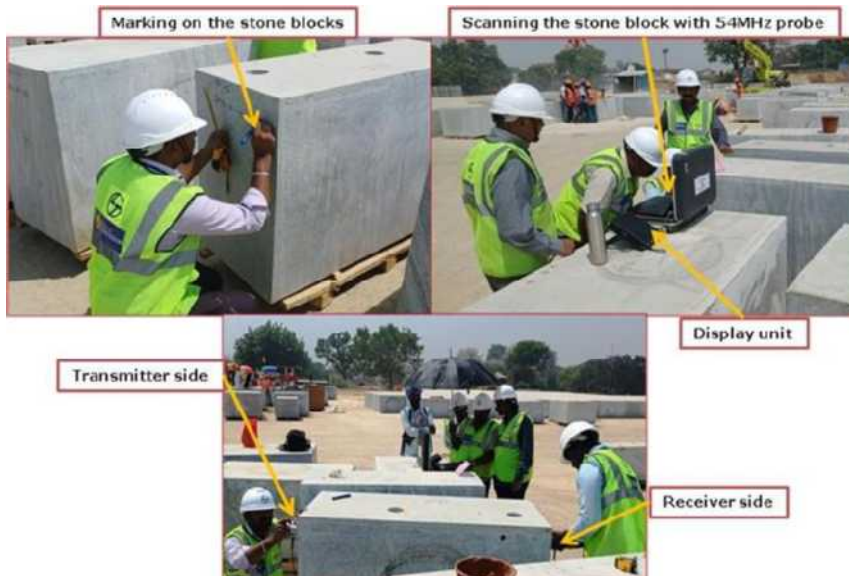
पत्थर के ब्लॉक के गुणवत्ता मूल्यांकन के लिए उपयोग की जाने वाली कुछ तकनीकें
