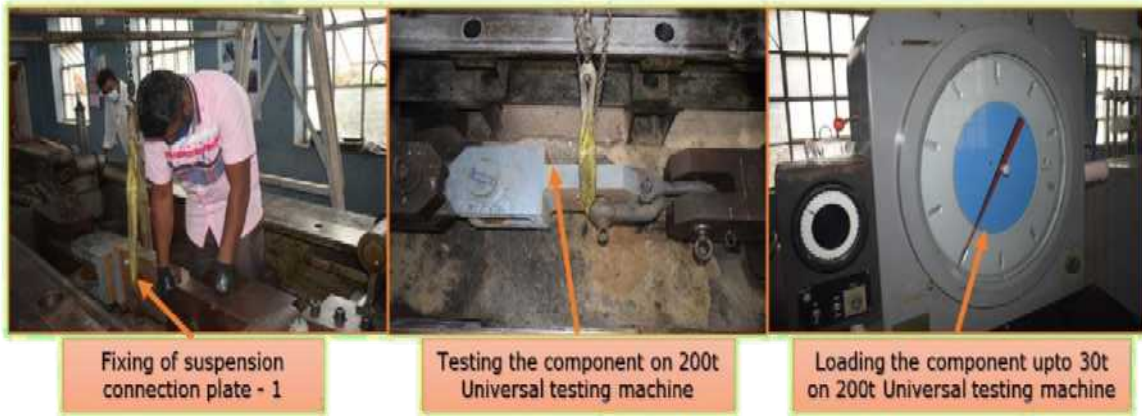
सस्पेंशन कनेक्टिंग प्लेट का परीक्षण
